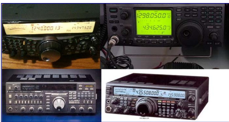
Παλαιότεροι και σύγχρονοι πομποδέκτες που δέχονται modules 1.2 GHz
