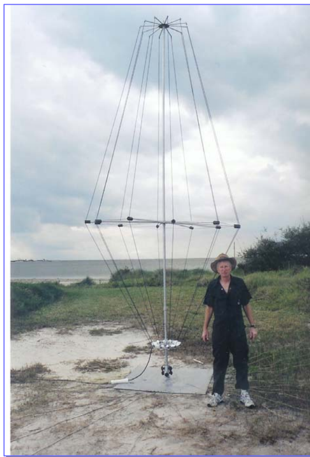
ΚΑΤΑΣΚΕΥΕΣ ΑΥΤΟΣΤΗΡΙΚΤΕΣ ΑΠΟ ΣΩΛΗΝΑ ΓΙΑ 6-30 MHz
