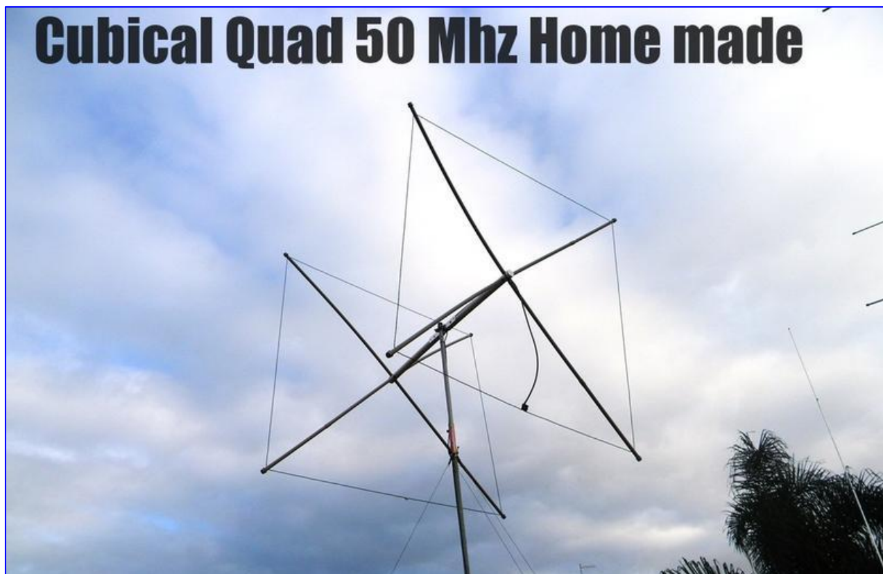
Ιδιοκατασκευή Κλασσικής Cubical Quad για τα 6m.
