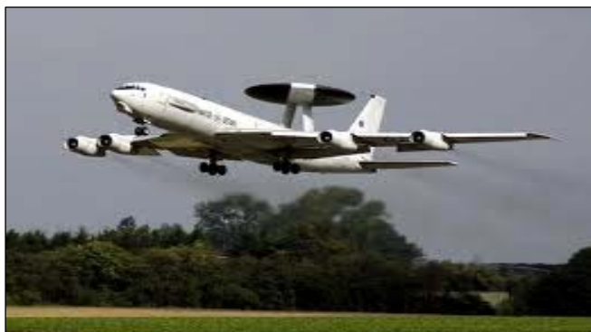
Τα AWACS και EMBAER ιπτάμενα Radar με τις καλυμμένες κεραίες σε Radome
