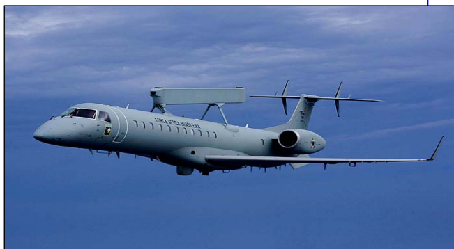
Τα AWACS και EMBAER ιπτάμενα Radar με τις καλυμμένες κεραίες σε Radome
