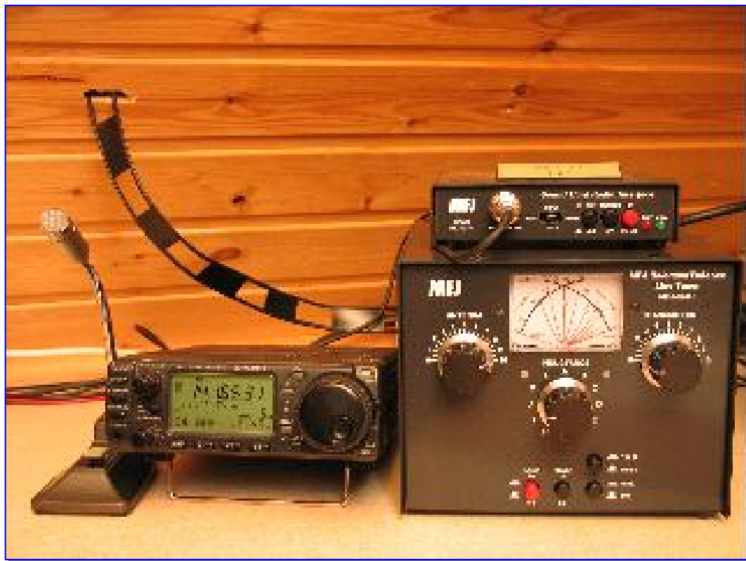
Το tuner έχει ασύμμετρη είσοδο και συμμετρική έξοδο.
