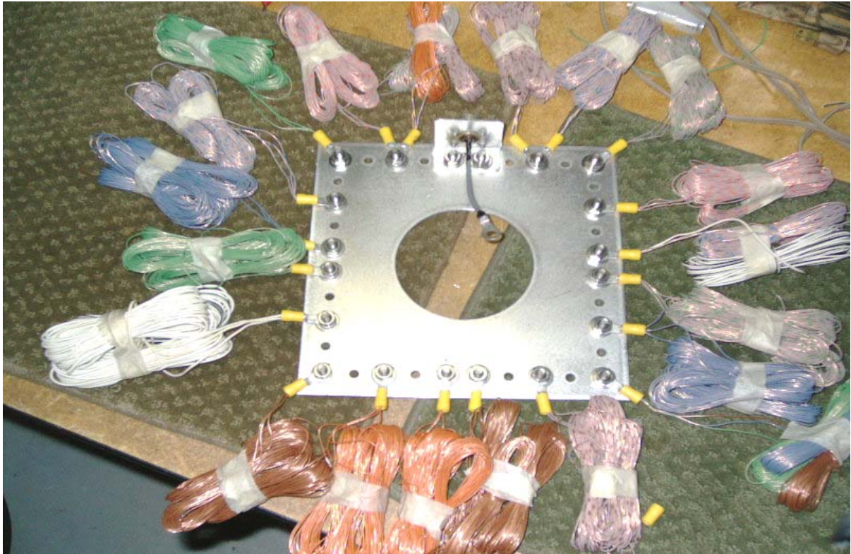
Η πλάκα του τεχνητού εδάφους με βιδωμένα περιμετρικά τα Radial.
