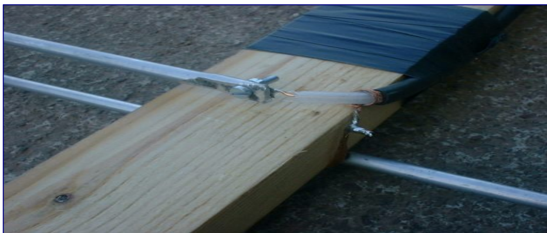
Η σύνδεση του οδηγού στοιχείου με τη γραμμή μεταφοράς.
