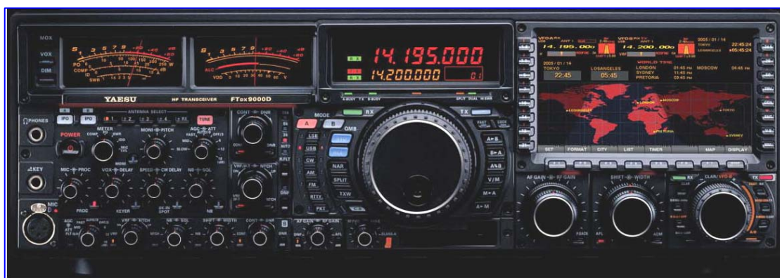
Πομποδέκτης βάσεως με ενσωματωμένο τροφοδοτικό.
