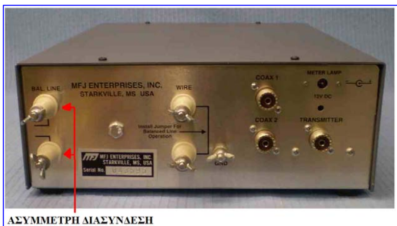
Antenna tuner με συμμετρική διασύνδεση.
