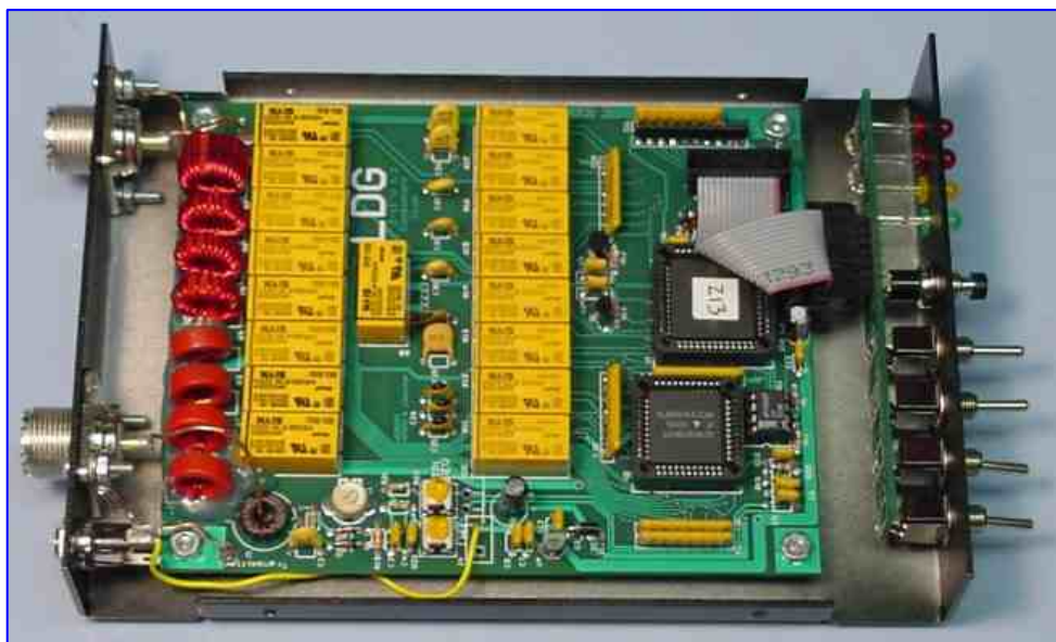
Το εσωτερικό ενός αυτόματου antenna tuner.
