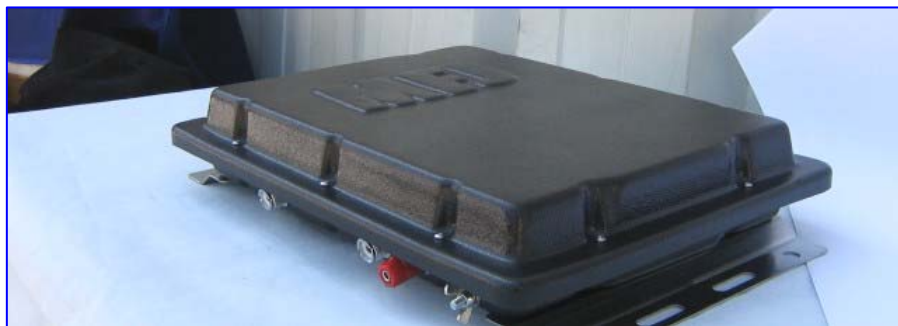
Εξωτερικό antenna tuner ιστού.
