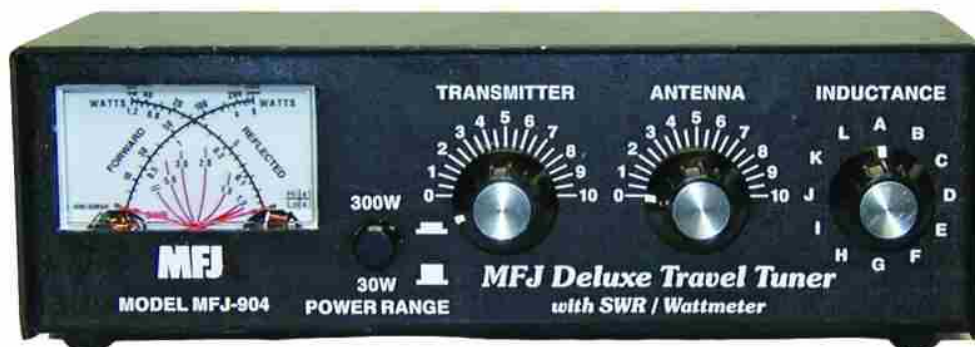
Antenna tuner Βραχέων κυμάτων πχ 3.5-30 MHz
