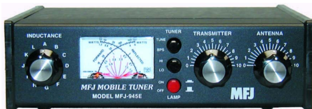
Antenna tuner ασύμμετρης γραμμής μεταφοράς.
