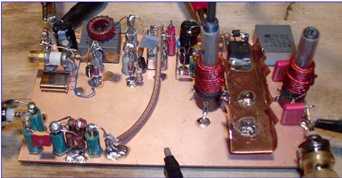
Το Transverter κατασκευασμένο.
