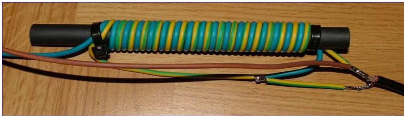
Ιδιοκατασκευασμένο Balun 4:1, επιτρέπει τη σύνδεση μιας ασύμμετρης γραμμής 50 ΩM σε μια κεραία Windom.
