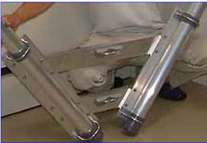
Τα U Bolts ανοξείδωτα. Επίσης δύο τμήματα για την οριζόντια στήριξη μεταξύ τους.
