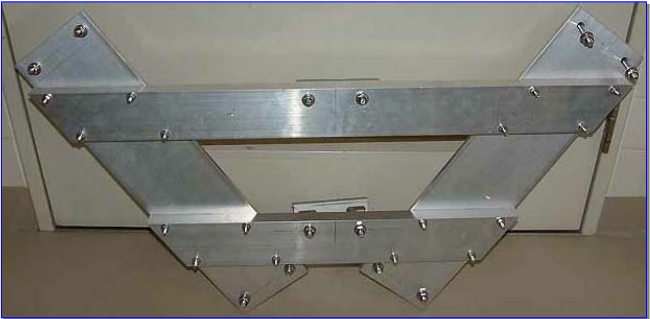
Τα U Bolts ανοξείδωτα. Επίσης δύο τμήματα για την οριζόντια στήριξη μεταξύ τους.
