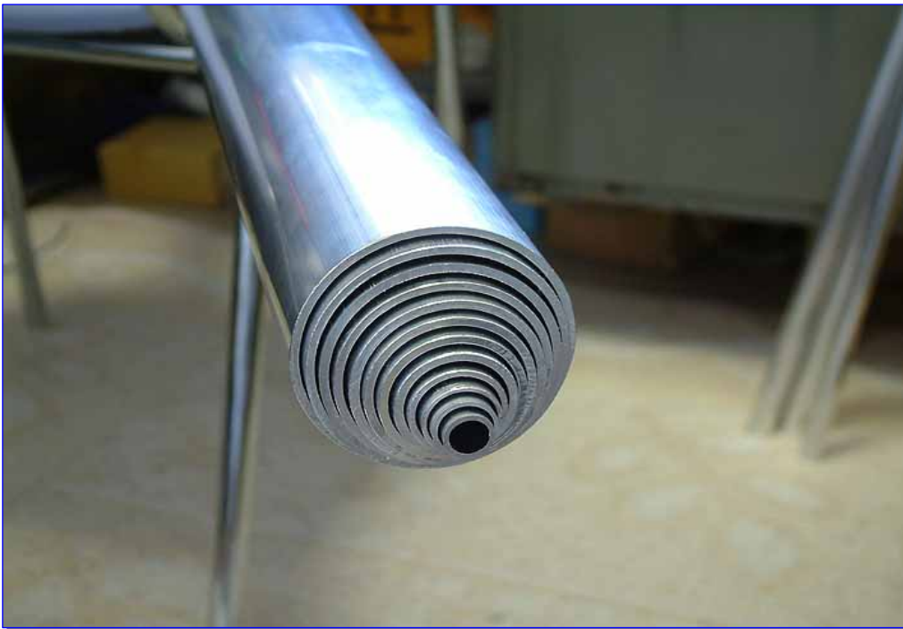
Σωλήνες αλουμινίου σε διατομή τηλεσκοπική .
