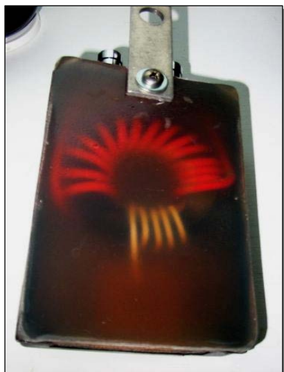
Ιδιοκατασκευασμένο Balun. Δείτε το πρωτεύον -κόκκινο και δευτερεύον - χρυσαφί τύλιγμα.
