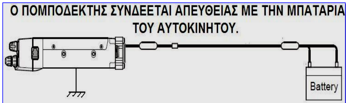
Απευθείας σύνδεση με τη μπαταρία και γείωση στο αμάξωμα του αυτοκινήτου.
