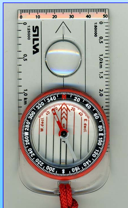
Οδοιπορική με αναγραφή Declination \pm 50^\circ
