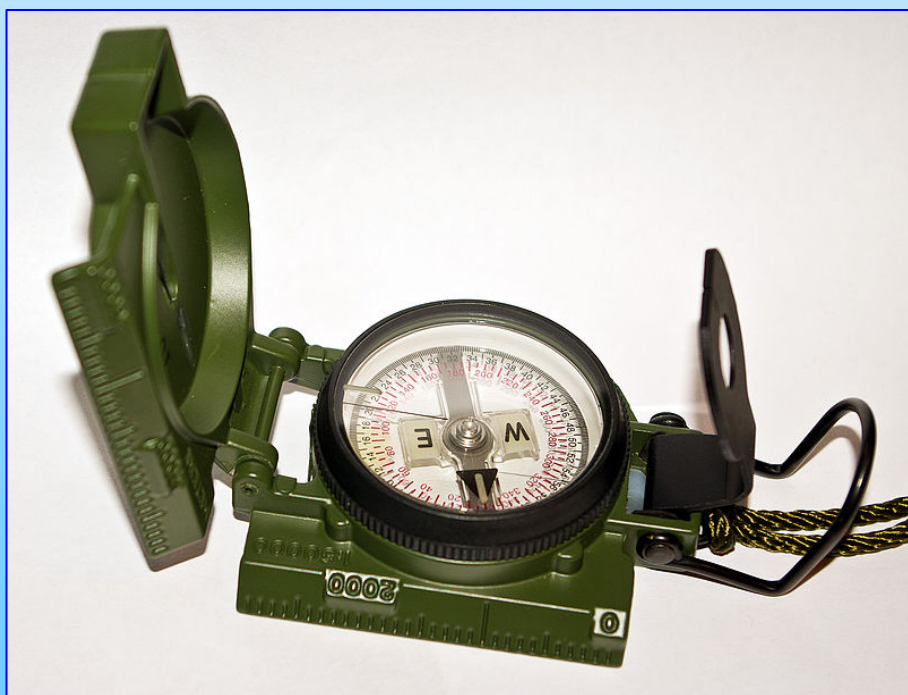
Lensamatic με φακούς διόπτρευσης
