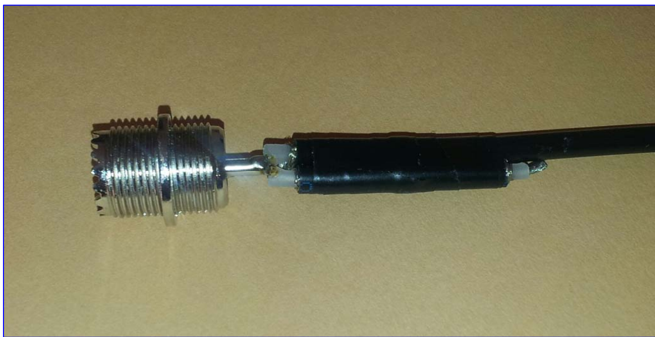
Το stub, σφικτά στερεωμένο με ταινία στο σώμα της κεραίας
