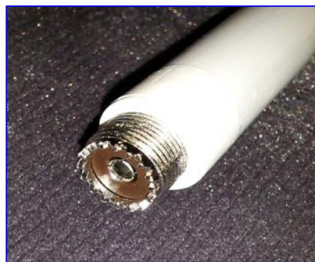
Το stub (αριστερή εικόνα) και το κλασσικό μας κονέκτορ SO239 προσαρμοσμένο σε σωλήνα Φ20
