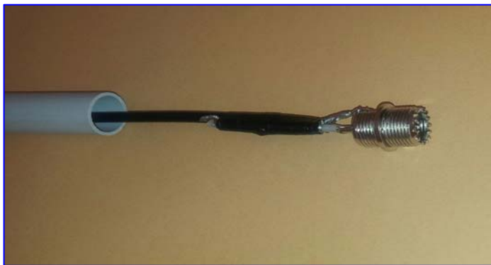
Το stub (αριστερή εικόνα) και το κλασσικό μας κονέκτορ SO239 προσαρμοσμένο σε σωλήνα Φ20
