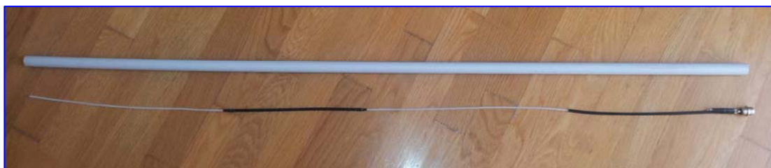
Η κεραία λίγο πριν τοποθετηθεί μέσα στην σωλήνα PVC, παρατηρείστε τα μπλεντάζ Β & D
