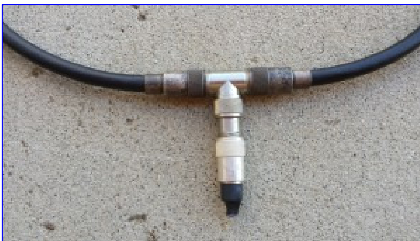
Η σύνδεση των εργοστασιακών Bleeder με την κάθοδο / κεραία.
