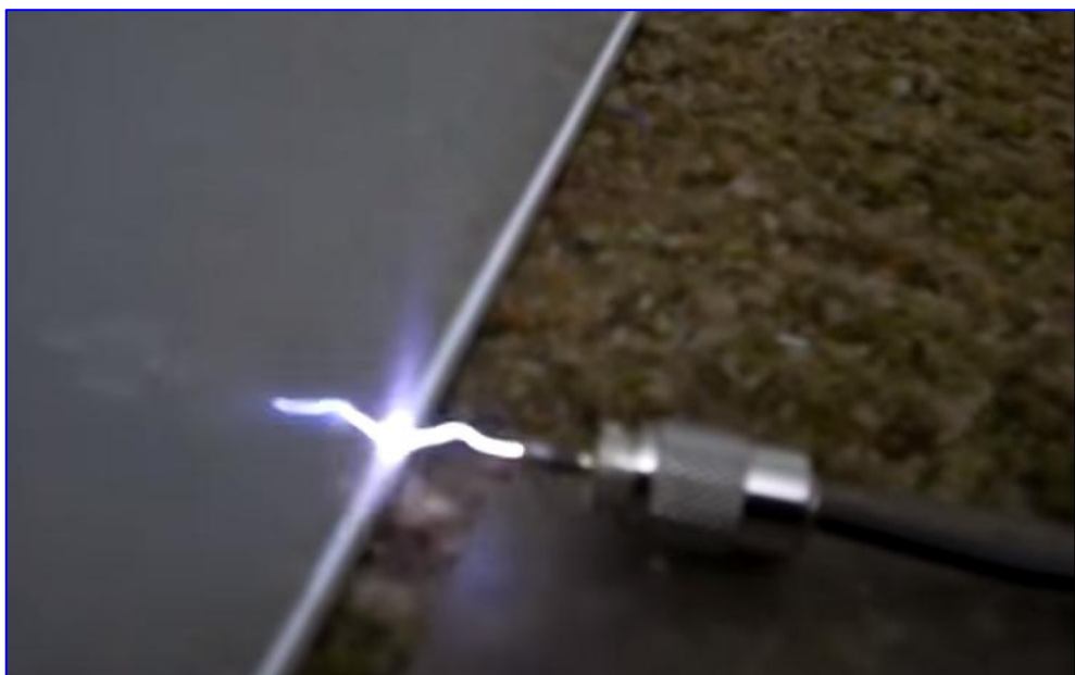
Εκφόρτιση στατικών φορτίων ραδιοερασιτεχνικής κεραίας βραχέων κυμάτων.
