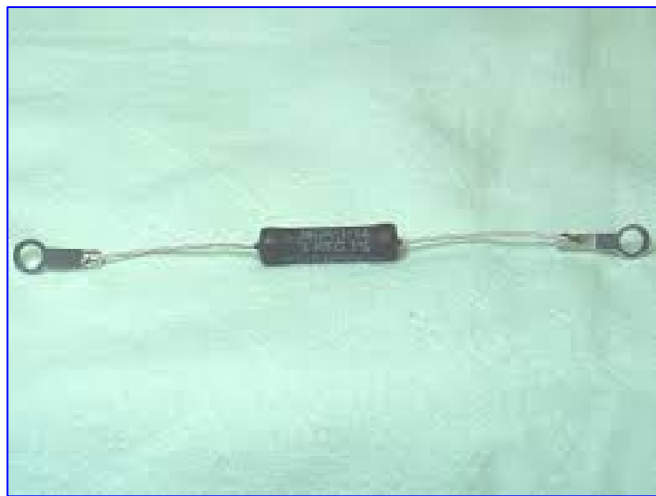
Ειδική αντίσταση Bleeder «υψηλής τάσης» με ακροδέκτες σύσφιξης.
