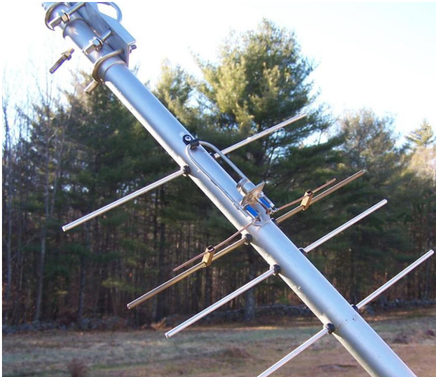
T MATCH ANTENNA. Και όμως, είναι ιδιοκατασκευή!
