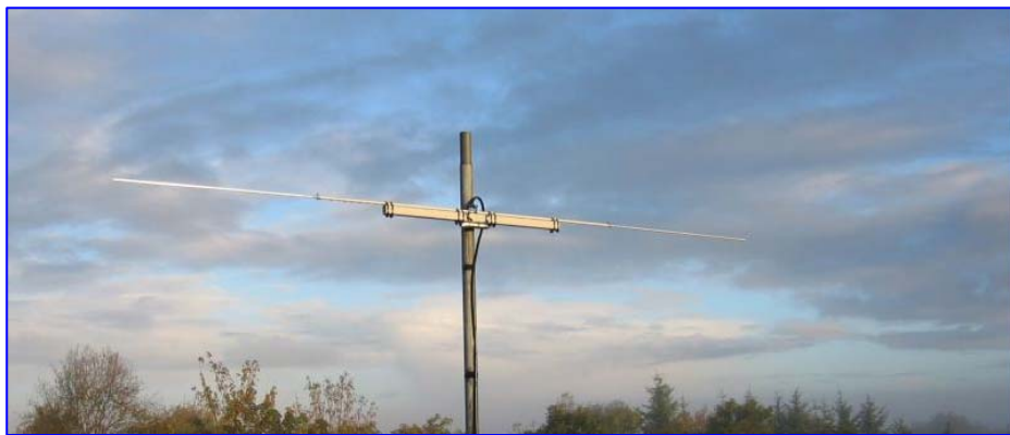
Home made Δίπολο για τους 70 MHz. Έσχατη λύση, αλλά «δουλεύει»!
